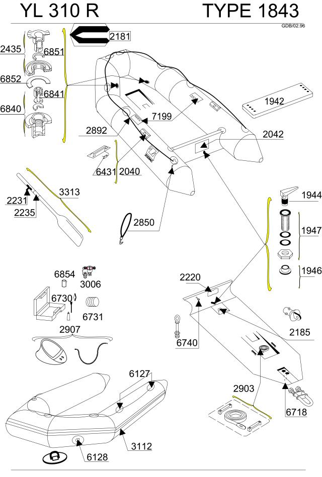
Tissu pour réparation: Corps = 7197 Blanc Fabric for repairs : Tube = 7197 White
